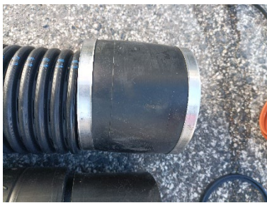
Bilincses gumi idom HD-PE perforált szivárgóhoz rögzítve
